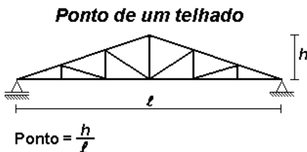
Figura 20 – Inclinação e ponto de uma tesoura
